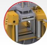
[ Hydrauliczny ] docisk górny Hydraulic upper clamp
