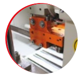
[ Hydrauliczny ] przewodnik ostrza Hydraulic blade guide
